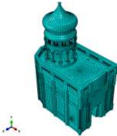
Σχήμα 14.30.: Προσομοίωμα πεπερασμένων στοιχείων του Ιερού Κουβουκλίου του Παναγίου Τάφου.
